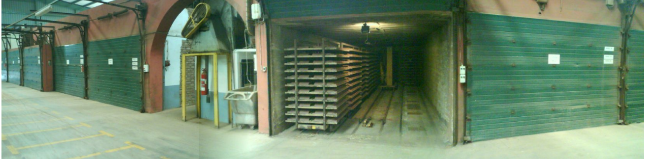
Figura 20 – Exemplo de um secador estático com várias câmaras
