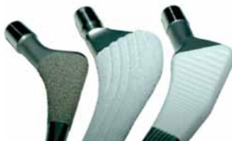
Implantes metálicos revestidos por pulverização por plasma. Da esquerda para a direita: com titânio, com titânio e hidroxiapatite e com hidroxiapatite (Fonte: Ceramed)
