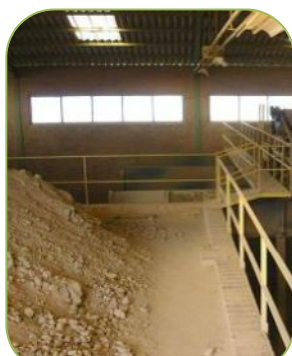
Figura 46 - Armazenamento da matéria-prima em nave fechada
