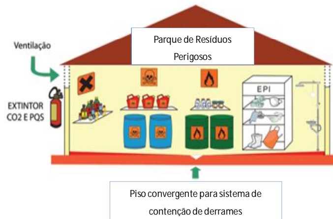
Figura 31- Esquemática de um parque exclusivamente para resíduos perigosos
