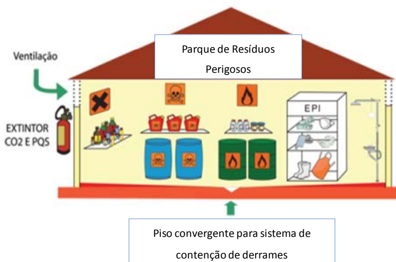
Figura 24 - Esquematização de um parque exclusivamente para resíduos perigosos
